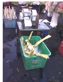
Petite machine à jus de canne mue par un moteur à combustion.
