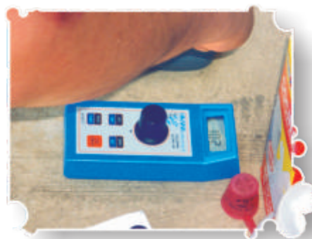
Fig. 20. Medición de partes por millón de cloro con aparato digital.
