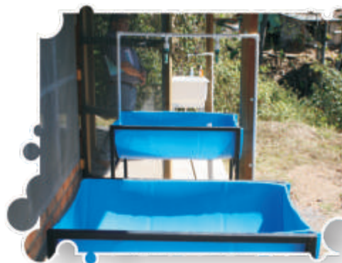
Fig. 5. Tecnología de tanques utilizada por ASOPROL para lavado y desinfección.
