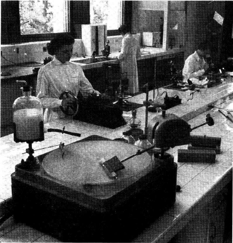
Affûteuse automatique des couteaux de microtome.
