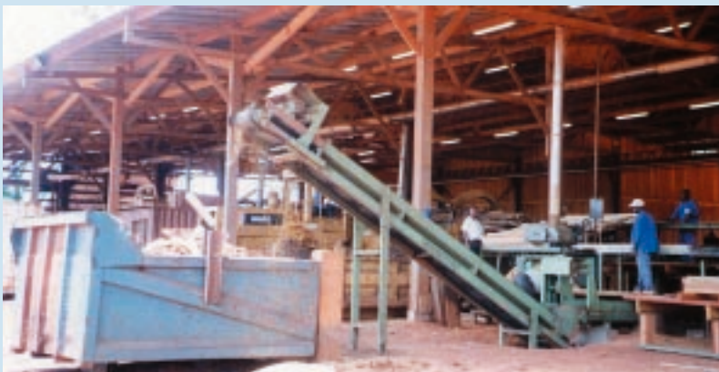
Matériel d'évacuation automatique des chutes de sciage. Mindourou, Cameroun. Automatic evacuation of sawmill residues. Mindourou, Cameroon. Photo F. Pinta.
