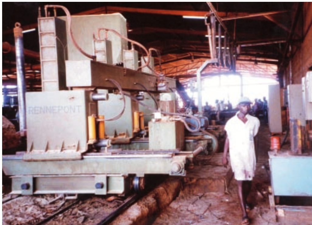
Des scies de tête robustes : exemple de scie à grume rencontré au Cameroun. Robust headsaws seen in Cameroon. Photo F. Pinta.
