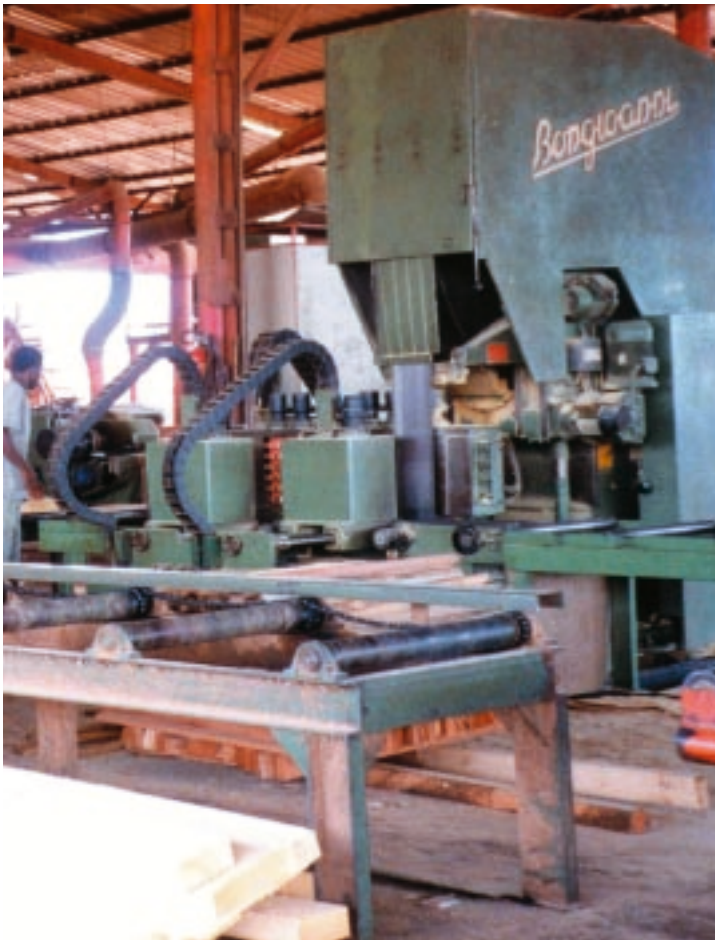
Ruban dédoubleur de grand diamètre à entraînement motorisé. Libongo, Cameroun. A motorised wide-diameter splitsaw. Libongo, Cameroon. Photo F. Pinta.
