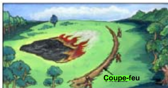
Figure 14 Construction d'un coupe-feu pour l'attaque indirecte de feux Source : Nicolas, et.al.[21], 1999.
