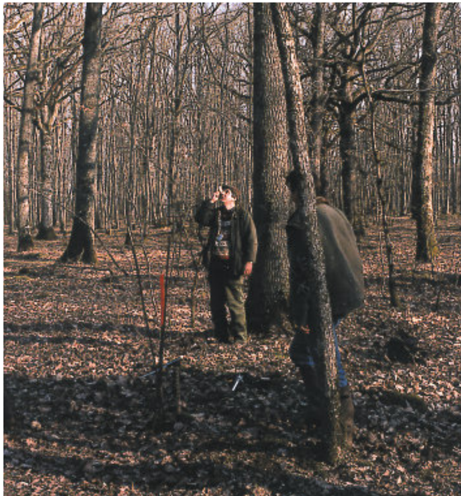
Mesure de la hauteur au dendromètre. Photo : X.PESME.
