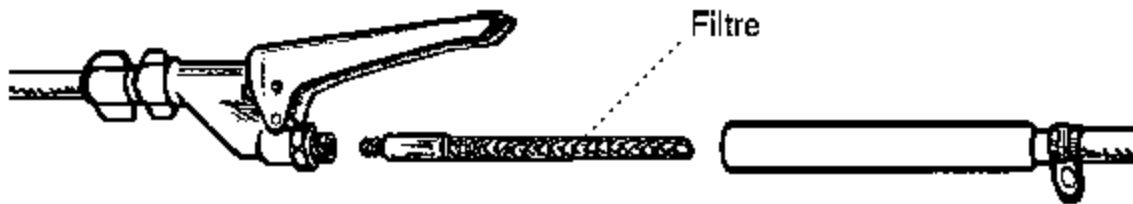
Fig. 9.17 Démontage du filtre pour nettoyage (© OMS).
