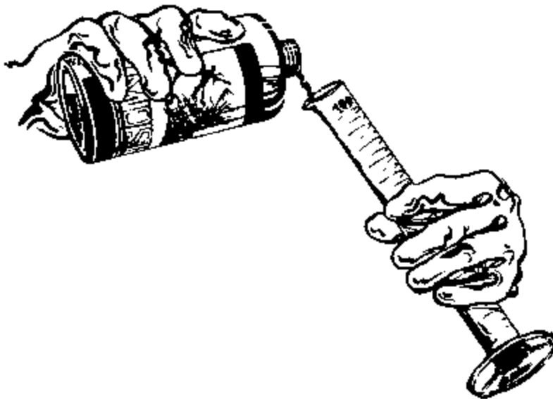
Fig. 1.72. Mesure de la quantité de concentré nécessaire à l'aide d'une éprouvette graduée
