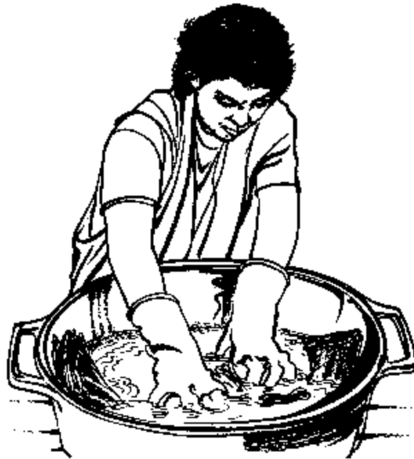
Fig. 1.73. Imprégnation d'une pièce de tissu par pressage et trempage. Il faut porter des gants de protection en caoutchouc.
