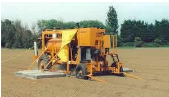
Appareil de traitement à la vapeur (« cloches » à vapeur)
