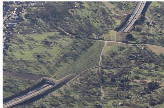
Cet écoduc (près de Stuttgart) n'a pas permis de supprimer certaines petites routes qui fragmentent encore le paysage, mais il limite très fortement l'effet fragmentant de l'autoroute
