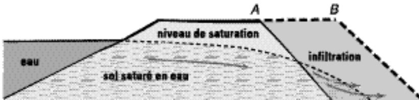
► Figure 6. Localisation de la terre saturée en eau dans une digue
