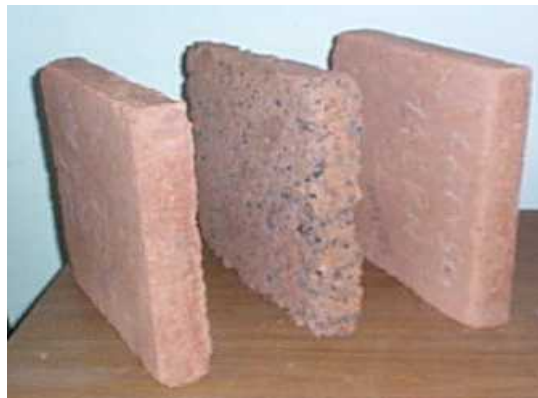
Figure 3.3 : Trois éprouvettes en latérite (à droite), latérite+pouzzolane ( au milieu) latérite+ sciure de bois (à droite)
