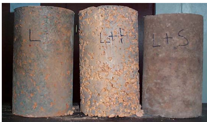
Figure 4.2: Epreuves de forme cylindrique ; à gauche : latérite, au centre : latérite + pouzzolane et à droite : latérite + sciure de bois.
