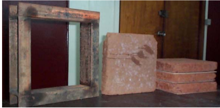
Figure 3.1 : Moule (à gauche), une éprouvette en latérite + sciure de bois (au centre) et un lot de trois éprouvettes (à droite)
