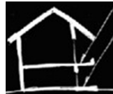
↑ Protections contre le soleil : Avancées de toits, balcons
