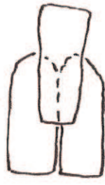
Principe du double chevauchement des pierres
