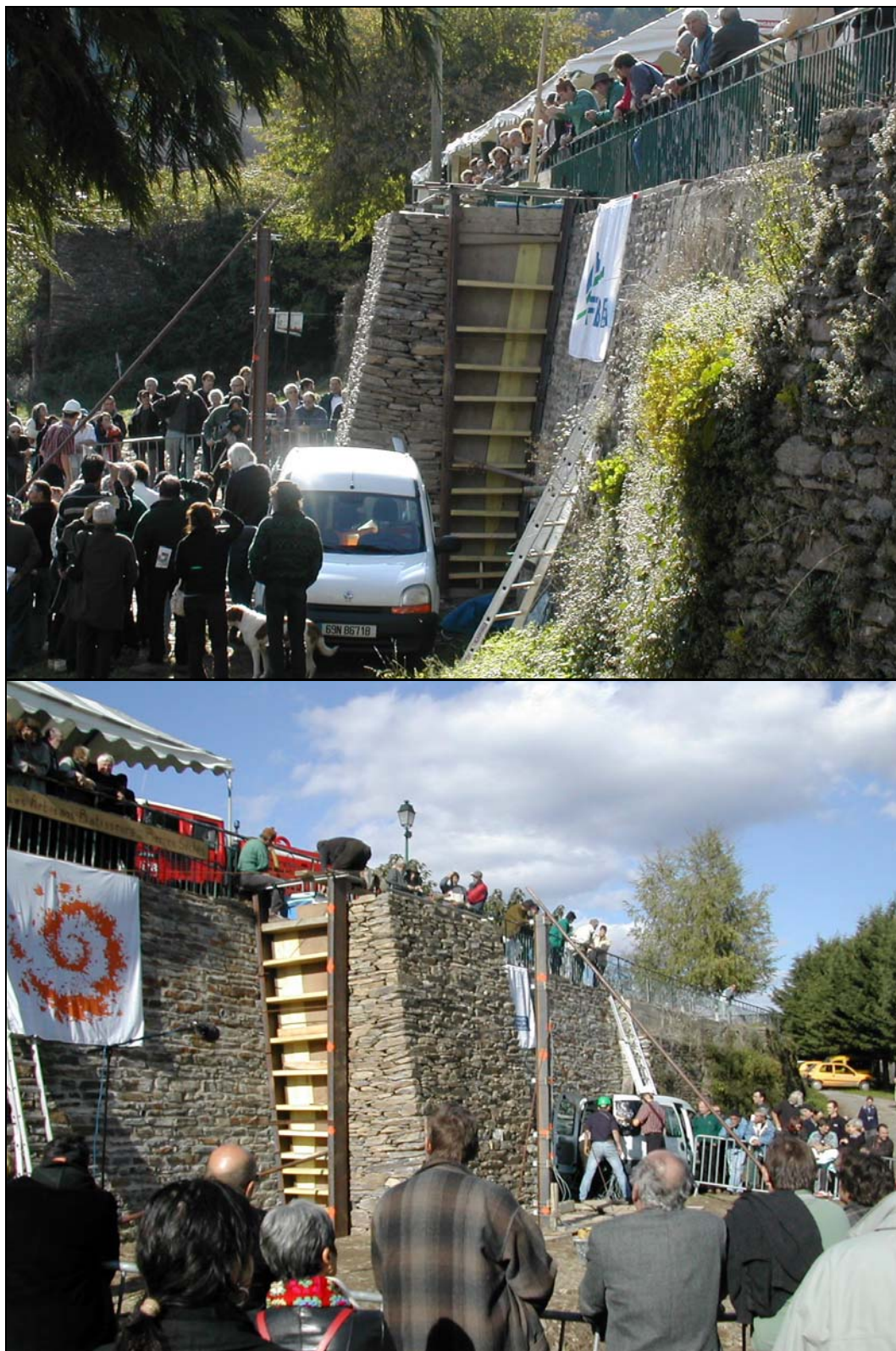
Figure V-7 : vues d'ensemble pendant la mise en charge du mur 5 ; le remplissage de la bache de chargement est fait par un camion de pompiers, situé au-dessus du mur de soutènement de la place.
