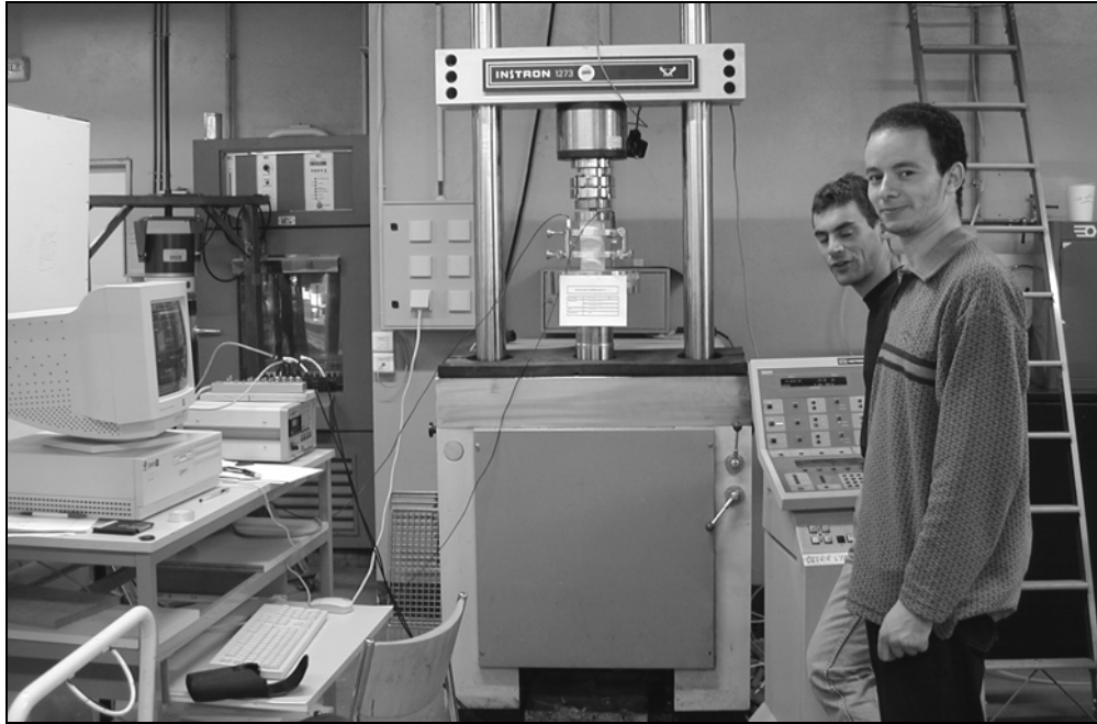
Figure III-1 : dispositif expérimental de compression du LGM-ENTPE.
