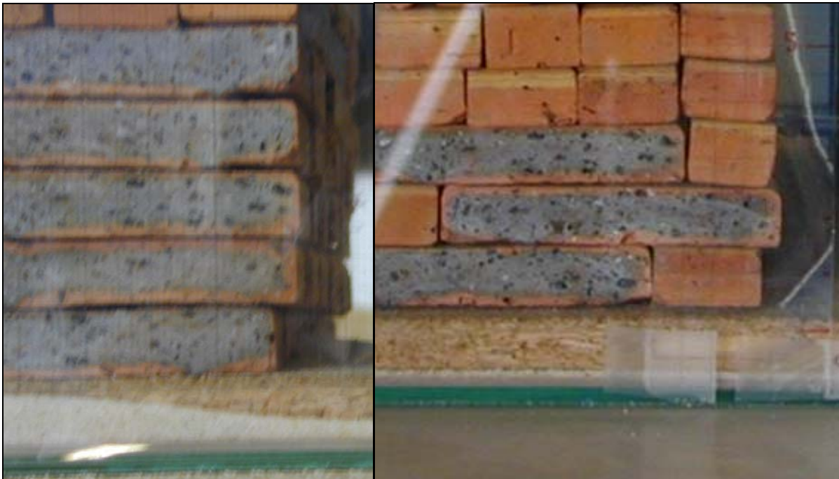
Figure III-24 : zooms sur le glissement interne, qui survient sur le premier lit de briquettes pour les murs C et D (le décrochement est visible par rapport au premier lit de briquettes). Le plan de rupture est horizontal (pas de réarrangement des blocs en rotation, i.e. \omega=0 ) et le coefficient de stabilité F_g au glissement est proche de 1.
