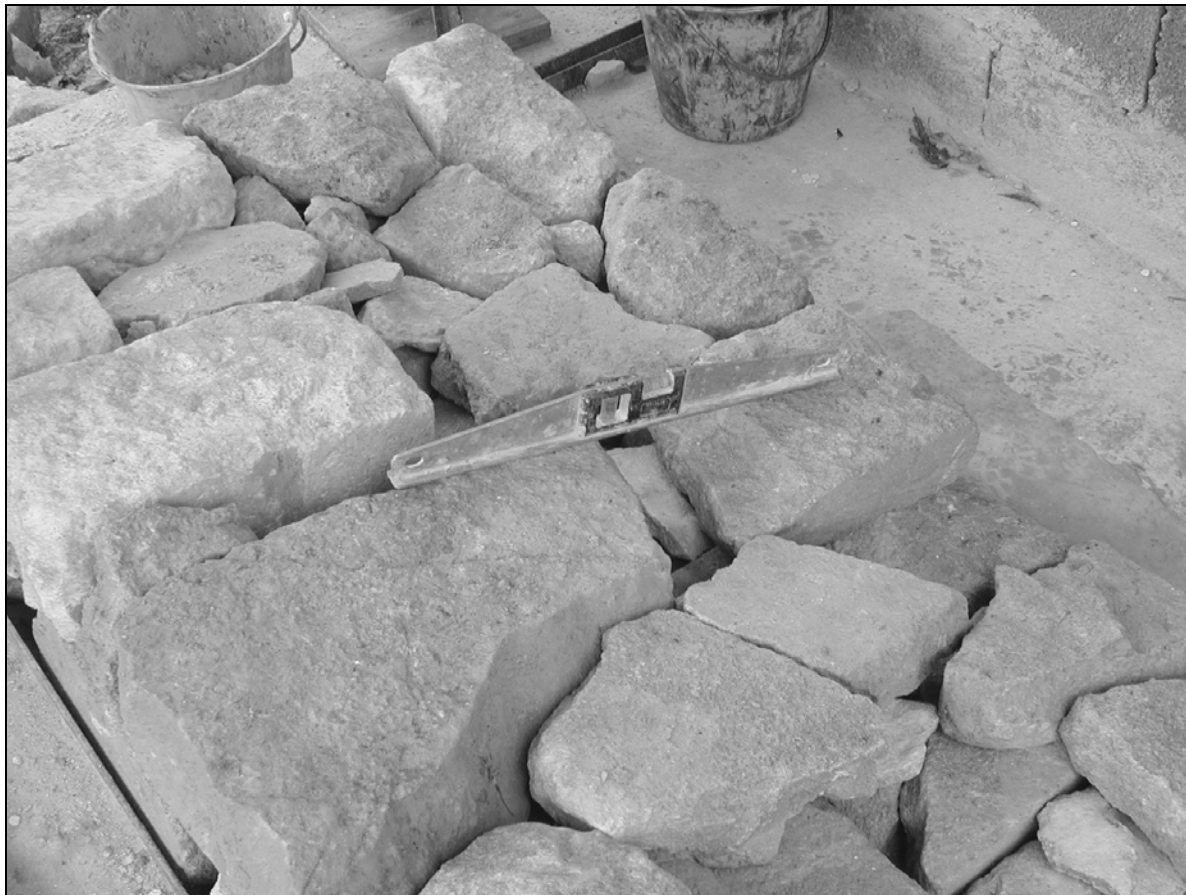
Figure IV-11 : croisement des joints sur les pierres posées sur les capteurs de force (mur 4).
