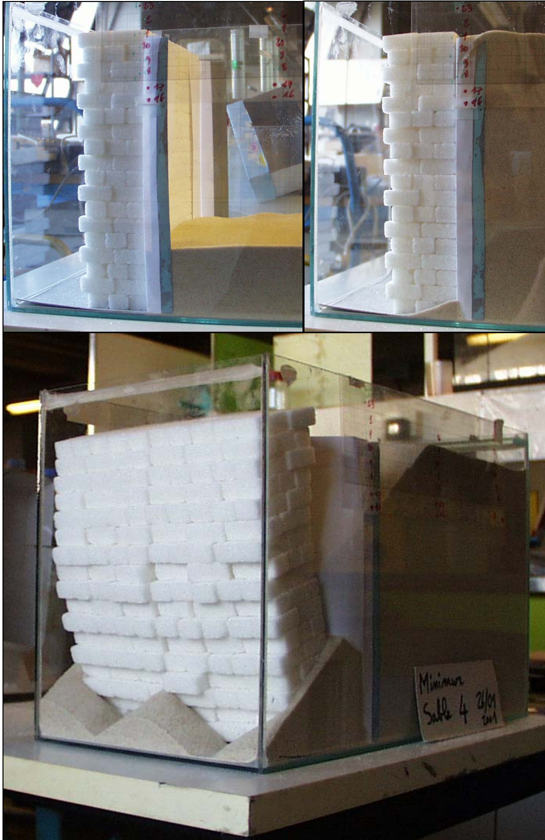
Figure III-23 : renversement du mur H selon un plan de rupture incliné, avec un coefficient de stabilité au renversement F_r proche de 1 et une excentricité relative k proche de 0,5.
