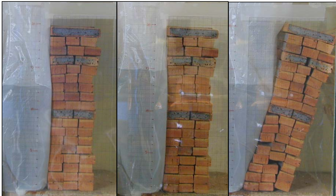
Figure III-21 : renversement du mur B sur l'arête avant avec un plan de rupture incliné, un coefficient de stabilité au renversement F_r proche de 1, et une excentricité relative k proche de 0,5.
