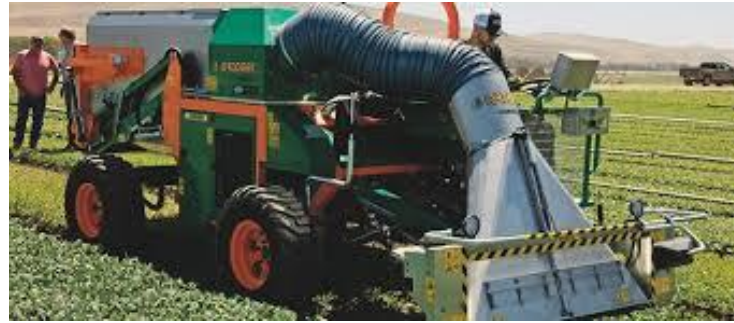
L'Ortomec Cleaner 2 utilise un aspirateur à haute puissance pour aspirer des insectes, des vers et des plantes végétales mortes dans les produits frais juste avant leur récolte. Photo Sutton Agricultural enterprises.
