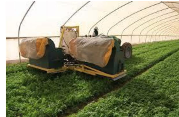
L'Ortomec Cleaner 2 utilise un aspirateur à haute puissance pour aspirer des insectes, des vers et des plantes végétales mortes dans les produits frais juste avant leur récolte. Photo Sutton Agricultural enterprises.
