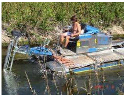
Faucardage (avec une faucardeuse) : fauchage ou arrachage d'une plante aquatique envahissante.
