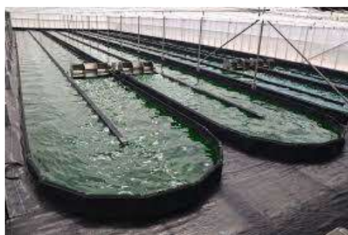
Bassins en hippodrome, avec une roue à aube pour le brassage de l'eau
