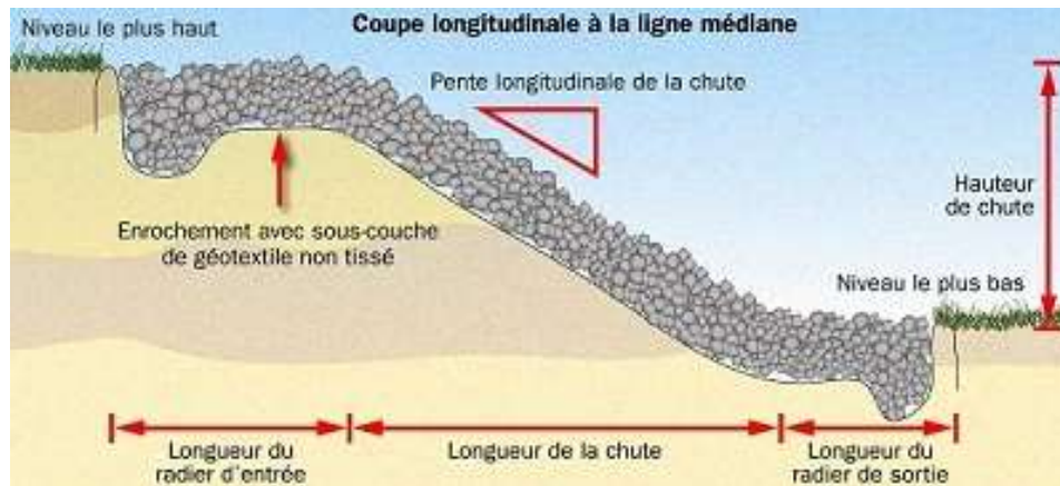
Déversoir enroché (coupe longitudinale). Source : MAAARO 167 .
