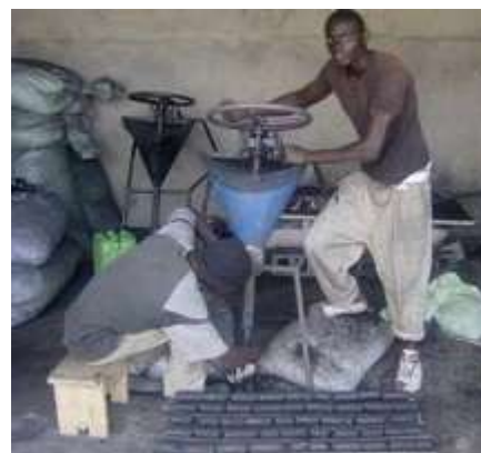
Production du biocharbon avec le Rotor Prestype (© Brades) (un compacteur ou presse).
