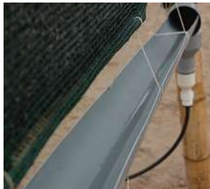
La gouttière ou goulotte permettant de récolter l'eau gouttant le long du filet 181 ,
