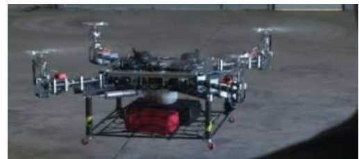
Ce drone, de la société Drone Hopper , équipé de capteurs thermiques, peut transporter 600 litres d'eau.
