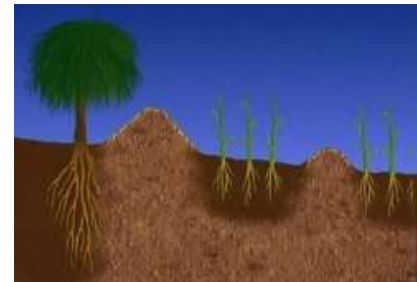
L'eau de la crue s'infiltré progressivement dans le sol (système des limans israéliens) Vidéo Water Harvesting in the Negev.
