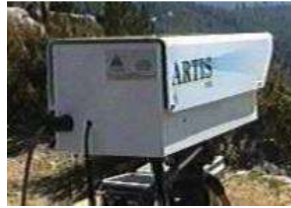
Caméra infrarouge système Artis Fire (efficace mais coûteux).
