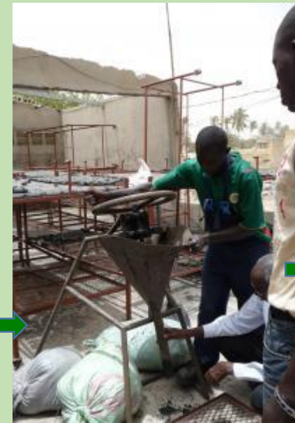
Compacteur de poudre de charbon vert avec un liant (BRADES).
