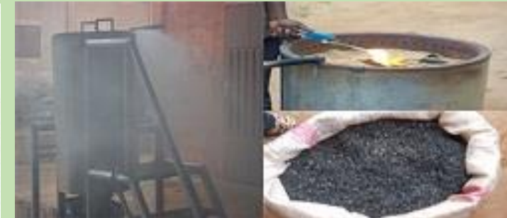
Production de biochar (charbon vert issu de la carbonisation de déchets ligneux, bois typha ...)
