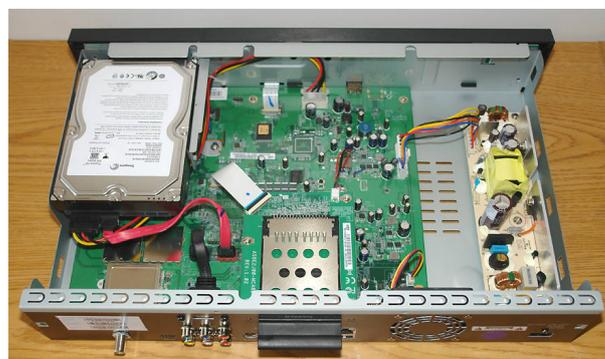
FIGURE 4 – L'intérieur d'un enregistreur vidéo numérique
