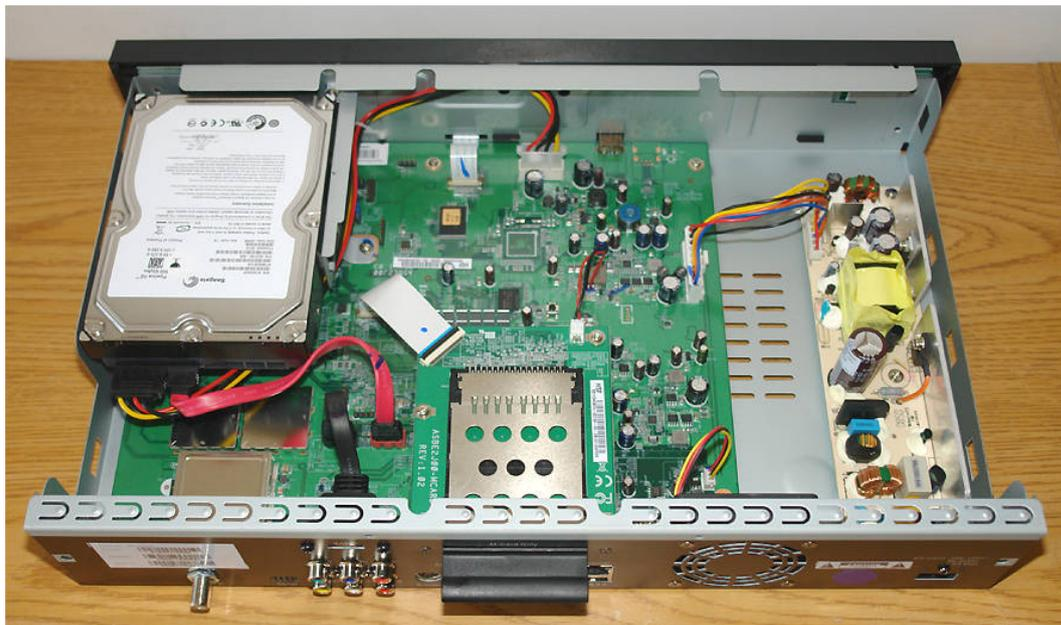
FIGURE 44 – Intérieur d'un DVR à disque-dur
