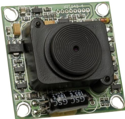
FIGURE 30 – Caméra "pinhole"
