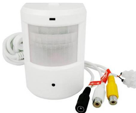
FIGURE 15 – Caméra cachée dans un IRP
