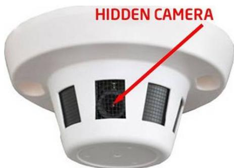
FIGURE 14 – Caméra cachée dans un détecteur de fumée
