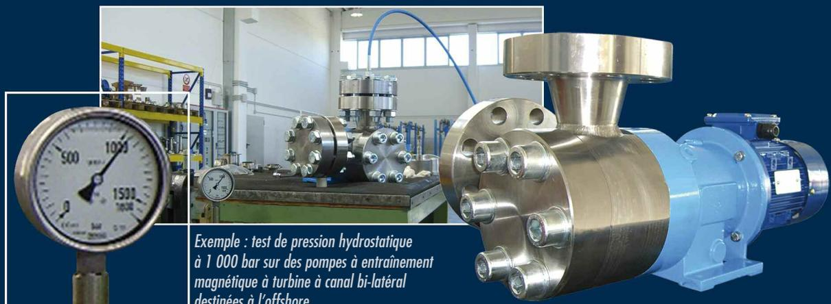
Exemple : test de pression hydrostatique à 1 000 bar sur des pompes à entraînement magnétique à turbine à canal bi-latéral destinées à l'offshore.
