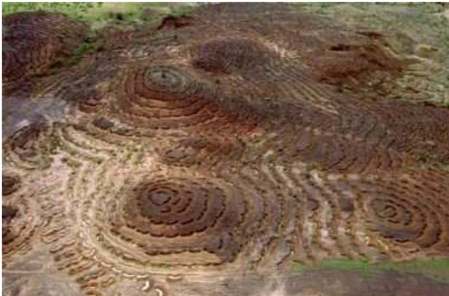
Photo 1 : Tranchées collinaires manuelles (vue aérienne) : Projet d'aménagement intégré de Keita (Niger) ; Photo F. Paladini 1989
