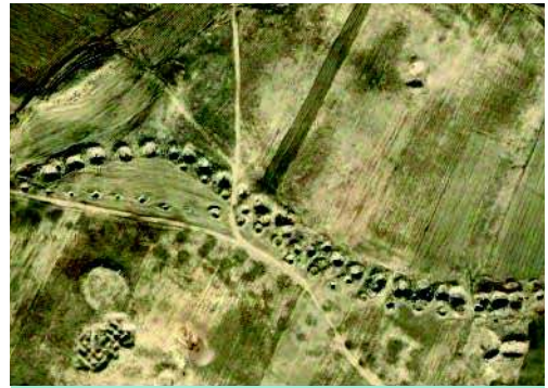
Vue aérienne d'un système de qanat en Iran avec les puits d'accès qui forment un chemin jusqu'au village. ( www.livius.org )
