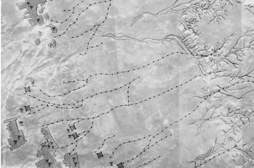
Photographie aérienne d'un système de Foggara alimentant les oasis de Timimoun en Algérie. Les tunnels de drainage souterrain est identifiable à partir des puits d'aération
