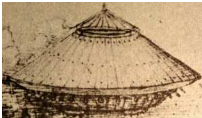
Le tank de Léonard de Vinci couvert de plaques en bois servant de cuirasse ou de blindage.
