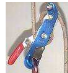
Fig. 171. 1) poignée d'ascension (ou Jumar) pour remonter une corde fixe. 2) jumar, 3) descendeur.
