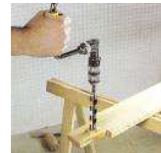
Perçage manuel d'un trou Dans la poutre porteuse Avec une perceuse manu.
