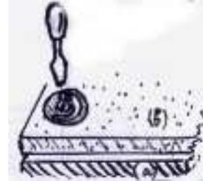
Fig. 73. Fixation des plaques décoratives (b) sur les plaques isolantes (a) Inspiré du système de liaisons entre éléments de meubles IKEA.
