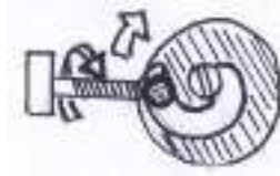
Fig. 73. Fixation des plaques décoratives (b) sur les plaques isolantes (a) Inspiré du système de liaisons entre éléments de meubles IKEA.
