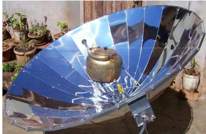
Ciseur Parabolique construit à Madagascar par ADES Solaire région de Toamasina ©Photo Benjamin LISAN
