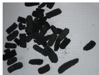
Gauche : rafle de maïs carbonisé issu du processus de gazéification (au 1 er plan)
