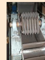
Panier de carbonisation à gauche et vue intérieure sur les marteaux du broyeur à droite.
