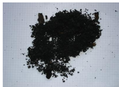
Gauche : Coque de cacahuète carbonisée issu du process de gazéification (au 2 nd plan)
