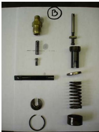
Pompe B démontée
