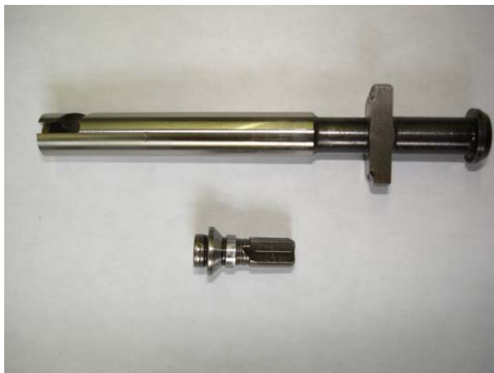
Élément de pompage et clapet de refoulement
