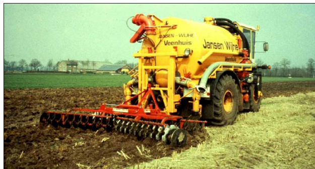
Matériel d'incorporation combiné à un gros réservoir
