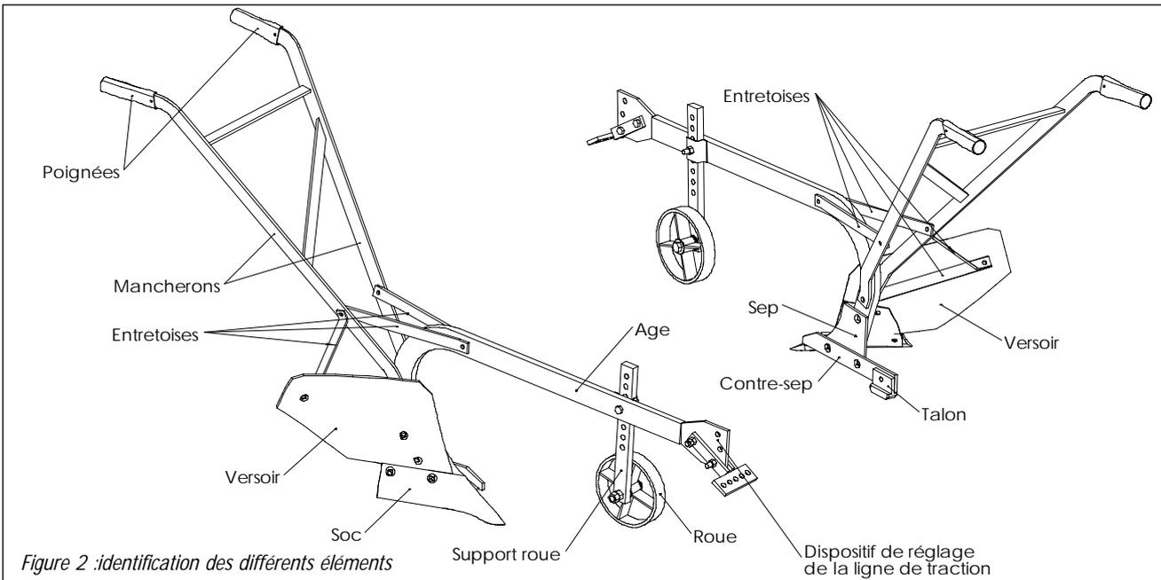
Figure 2 : identification des différents éléments
