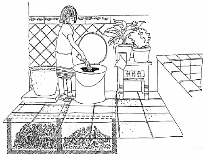
Figure 3- La coopérative de logement Gebers, à Stockholm, Suède. Séparation de l'urine, conteneur mobile pour le stockage des fèces. Un exemple d'adaptation d'un système d'éco-assainissement à un immeuble existant.
