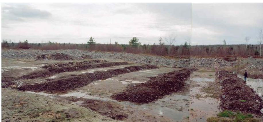
Fig. 4 : Andains de lombricompostage – fumier et carton déchiqueté
