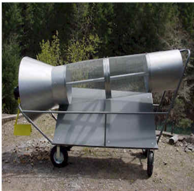
Fig. 5: À petite ou moyenne échelle, des récolteuses comme celle-ci conviennent pour récolter des centaines de livres de vers par jour.
