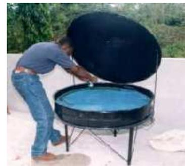
Figures 15a (à gauche) et 15b : Séchoir coquillage fourni par le GERES. © TECHNAP/CREDESA
