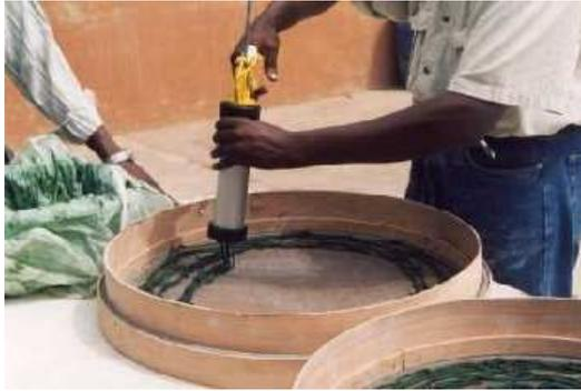
Figure 13 : Extrusion de spiruline essorée à l'aide d'un pistolet SIKA.
