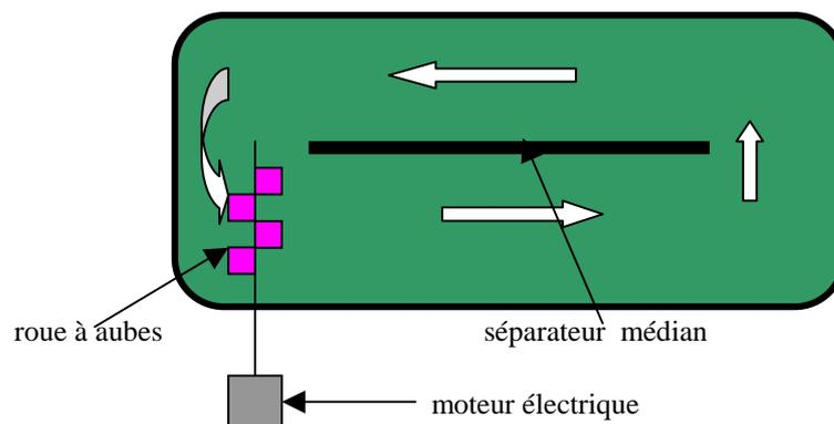
Le séparateur médian installé dans l'axe du bassin permet de réaliser une circulation en hippodrome. Les flèches indiquent le sens du liquide en agitation : on voit bien que la cloison centrale oblige le retour du liquide par l'autre bras de l'hippodrome.
