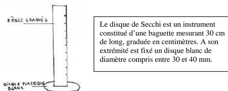
Figure 10 : Représentation d'un disque de Secchi.
