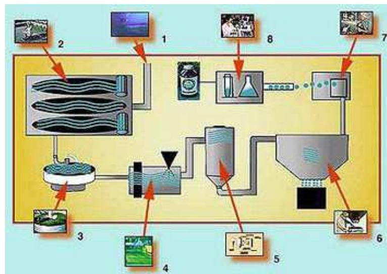
Figure 32 : Schéma représentant les huit étapes de la production de spiruline à Cyanotech Corporation. © Cyanotech Corporation 2006
