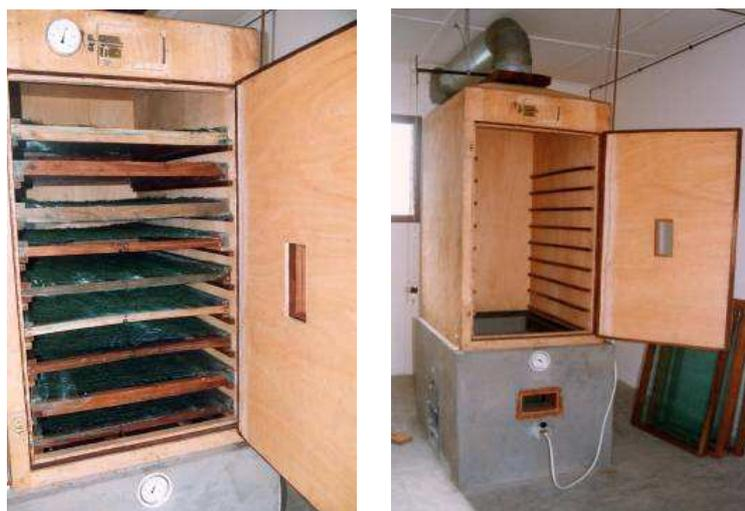
Figures 16a et 16b : Cabines de séchage (au Bénin) chauffées au gaz, permettant l'installation de neuf plateaux recouverts de spiruline essorée.
