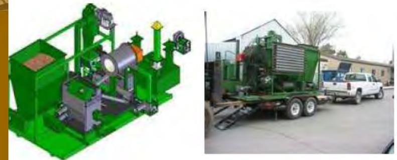
Unité mobile de pyrolyse d'une capacité de traitement de 1 tonne/jour (1 DTPD)
