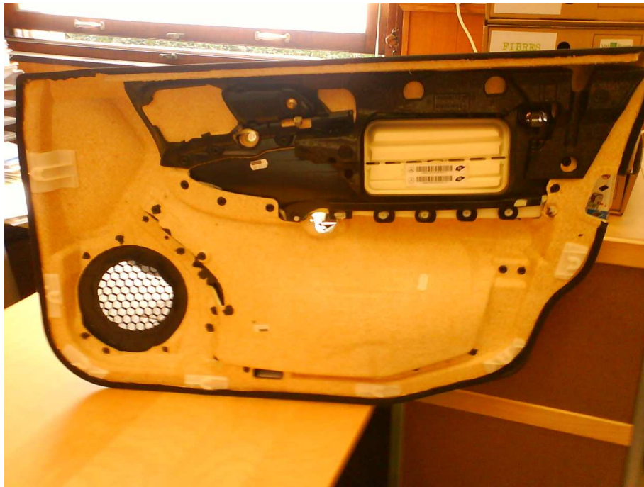
Figure 3 Intérieur de portière Mercedes à base de fibres de chanvre (Courtoisie de Vincent HOTTE)
