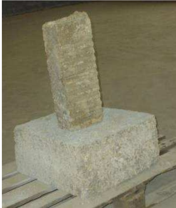
Figure 8 Brique et bloc à base de miscanthus 8
