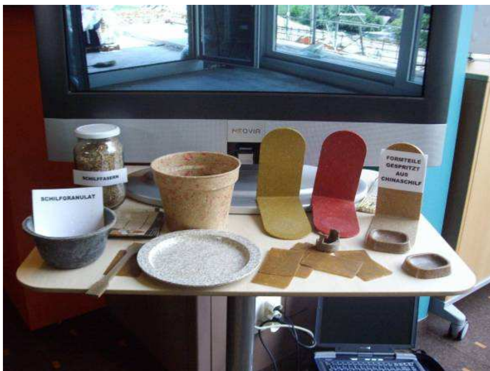
Figure 4 Exemples de pièces en composite à base de miscanthus 8
