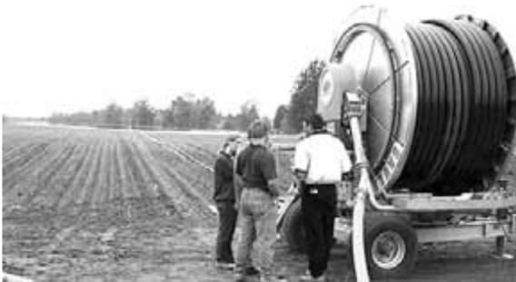
l'irrigation; simultanément, la rampe se replie facilement et le chariot dans sa position de transport est hissé hydrauliquement sur le support à tambour. Toute la structure est en acier galvanisé à chaud.
