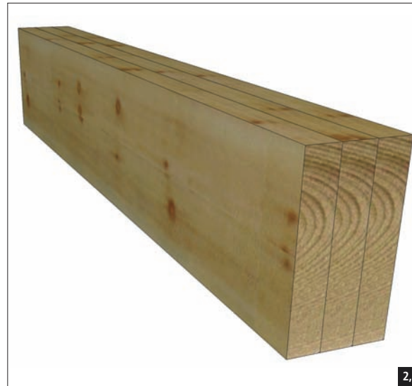
Fig. 2,5 Le bois lamellé-collé horizontal a les plans de collages perpendiculaires à la hauteur de la poutre.
