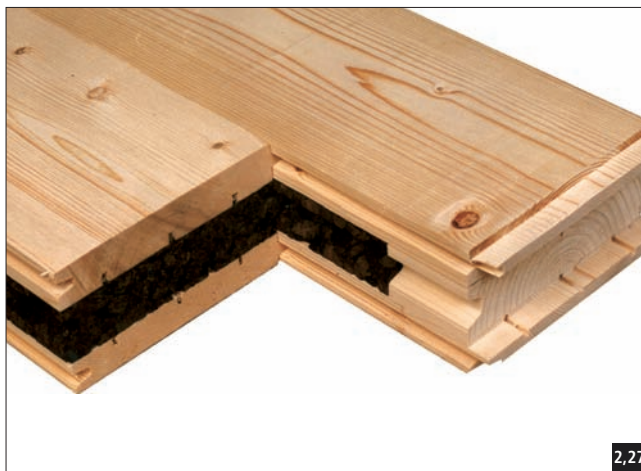
Fig. 2,28 Cet élément composite est employé en façade. Il a une finition extérieure. La languette assure la continuité de l'isolation et de la résistance mécanique.
