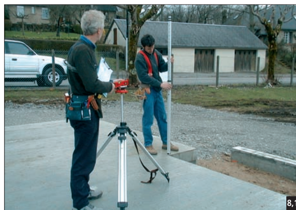
Fig. 8,14 Niveaux : pointeur laser et mire.
