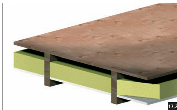
Fig. 17,26 Cette méthode permet de prendre des solives d'épaisseur inférieure à 60 mm pour une stabilité de 1/2 h.
