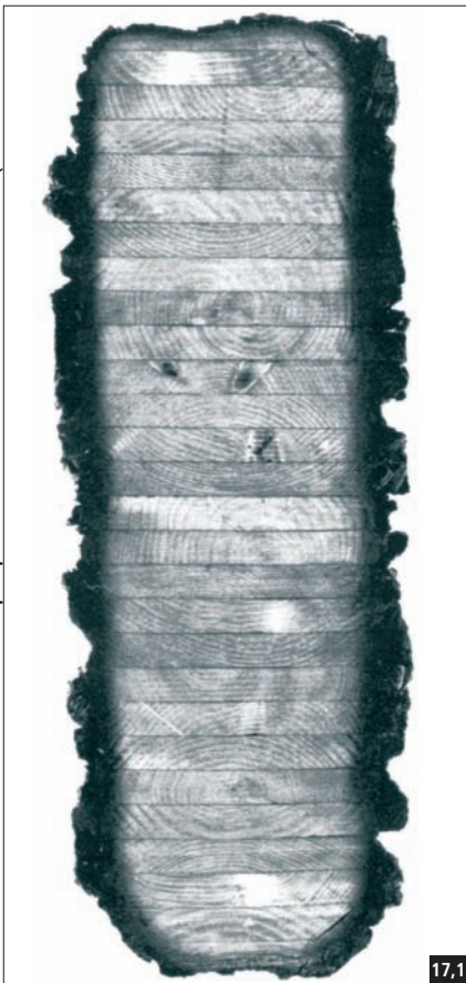
Fig. 17,1 La couche carbonisée protège les couches internes et ralentit l'avance du feu.
