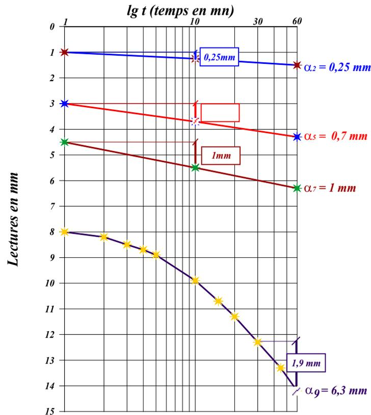
Fig. 2a Droites et courbes de fluage des 2<sup>ème</sup>, 5<sup>ème</sup>, 7<sup>ème</sup> et 9<sup>ème</sup> palier
