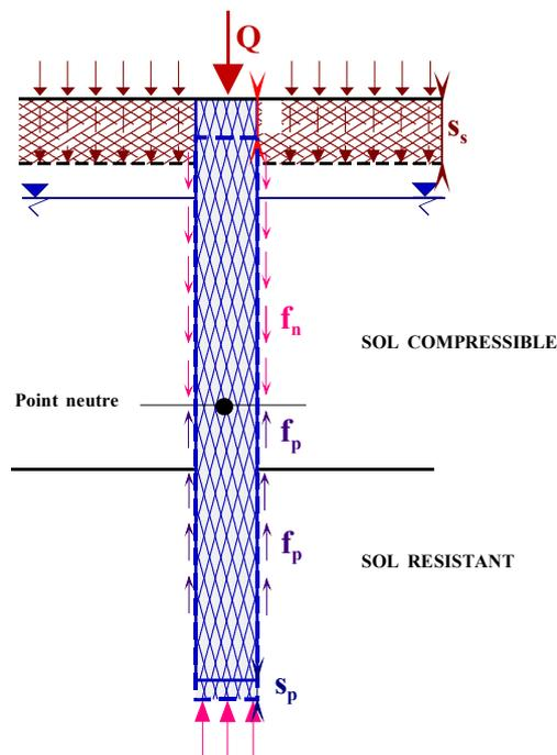
Fig.7 Mécanismes du frottement latéral positif et négatif
