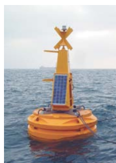
ESPAGNE - Port de Barcelone Suivi des tassements du fond de la mer sous une digue en construction
