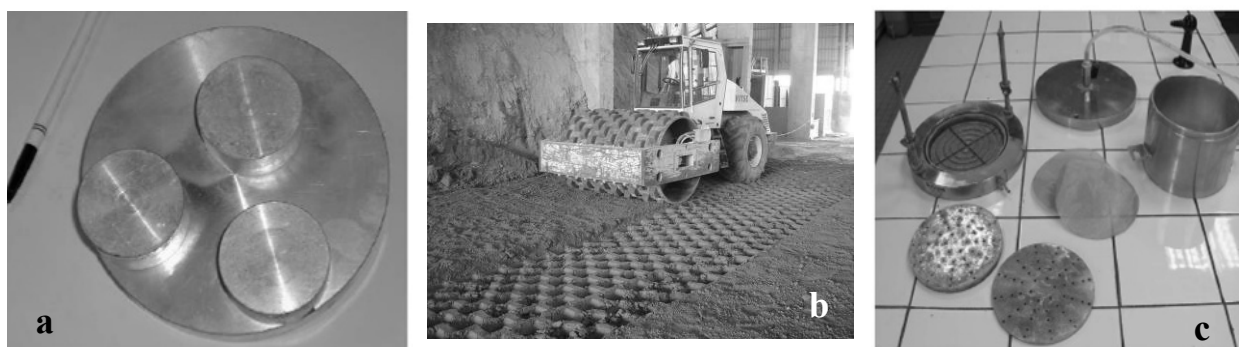
FIGURE 1: OUTIL DE COMPACTAGE PAR PETRISSAGE POUR LES ESSAIS DE LABORATOIRE (A), SIMULANT UN COMPACTAGE PAR PIEDS DAMEURS (B) ; PERMÉAMÈTRE (C).
