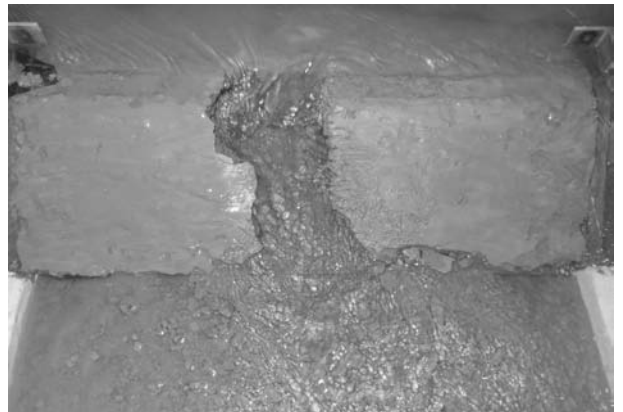
FIGURE 10 : T = 9 H : PHASE D'ELARGISSEMENT RAPIDE DE LA BRECHE.
