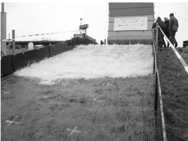
PHOTO 10: IN SITU TESTS DE FRANCHISSEMENT DES VAGUES
