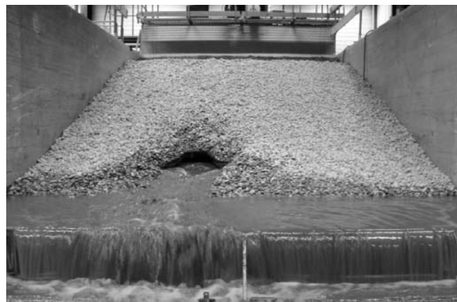
FIGURE 5: APPARITION DU RENARD HYDRAULIQUE APRÈS RUPTURE DE LA RECHARGE LORS DE L'ESSAI 4
