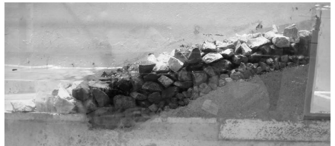
FIGURE 8 : CHANGEMENT DE PENTE ET PARAPET DE 2 M
