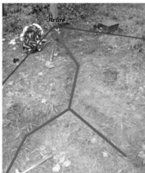
FIGURE 5 : CARTOGRAPHIE OBTENUE PAR MESURES DE RÉSISTIVITÉ ET PHOTO ILLUSTRANT LA RÉALITÉ
