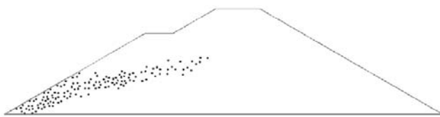
FIGURE 2: MODÉLISATION DES ZONES PLASTIQUES DU BARRAGE DE SKAWINA (POPIELSKI P. 2000)
