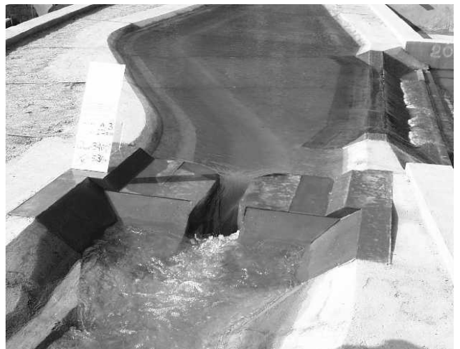
FIGURE 2 : MODÈLE PHYSIQUE SEUIL+DEVERSOIR (VUE AVANT)
