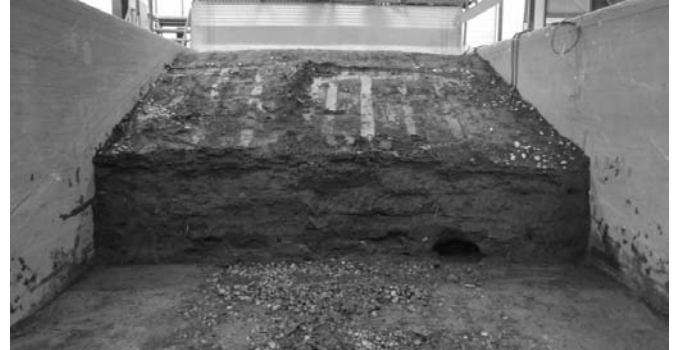
FIGURE 6: OBSERVATION DU CONDUIT LORS DU DÉMONTAGE DE L'ESSAI 6
