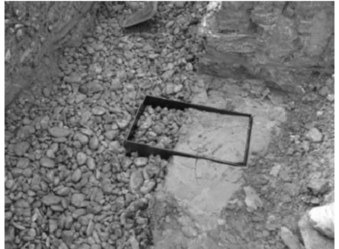
FIGURE 3. PRÉLÈVEMENT D'ÉCHANTILLON INTACT A L'INTERFACE TRANCHÉE/SOL (T2).
