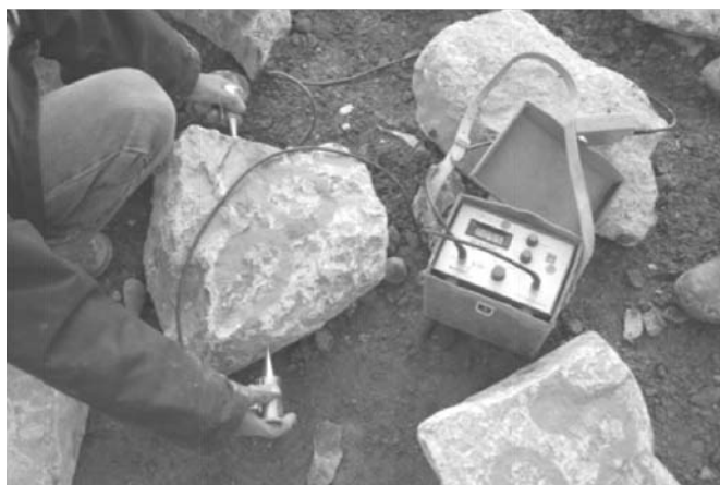
FIGURE 4 : MESURE D'INDICE DE CONTINUITÉ SUR BLOC
