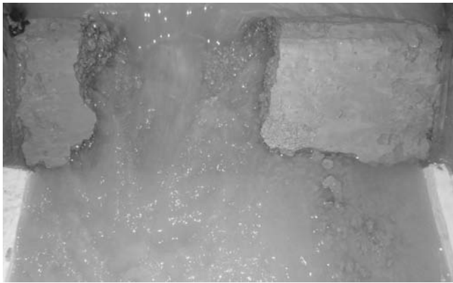
FIGURE 11 : ALLURE DE LA BRECHE ET DU JET SORTANT AU MOMENT DE L'ARRET DE L'ESSAI.
