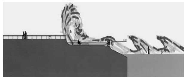
FIGURE 10: PRINCIPE DU BASSIN ATTÉNUATEUR DE VAGUES
