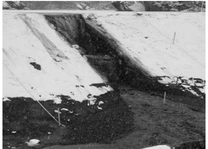
FIGURE 14 : PROJET IMPACT (2002) : PHASE DE HEADCUTTING PRECEDANT LA DEFAILLANCE DU PAREMENT COTE RIVIERE SUR UNE DIGUE DE 5M DE HAUT.
