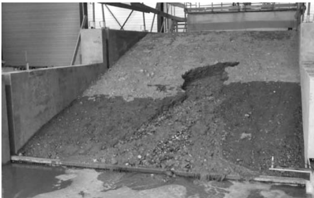
FIGURE 11: VENUE D'EAU ET RUISSÈLEMENT A LA SURFACE DE LA RECHARGE LORS DE L'ESSAI 11
