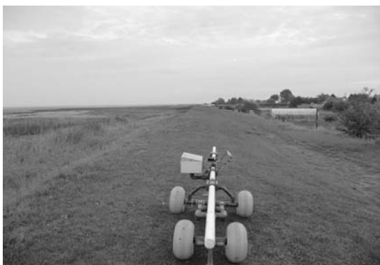
FIGURE 4: EM31 SUR SON CHARIOT EN CRÊTE D'OUVRAGE
