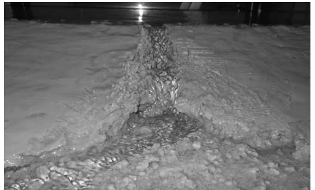
FIGURE 9 : DÉTAIL DE LA BRÈCHE À T=8 H.
