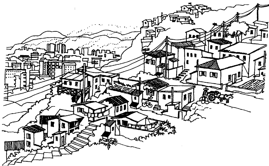
图5.2 使用生态卫生厕所系统的一个街区。每家都有自己的粪尿分集式脱水型或堆肥型厕所,挨着住房建造。储粪池用太阳能加热。市政工人收集尿、经过一次处理的粪便和厨房垃圾,并把它们带到街区自己的回收站。
