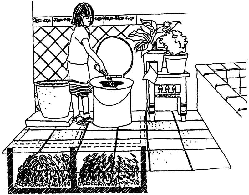
图3.5 越南双坑式厕所的墨西哥模式，建在库埃纳瓦卡市现代化的高标准住房的浴室里。有一个活动的带收集尿的坐便器，浴室地板下面是储粪池，可从住房外面开口。
