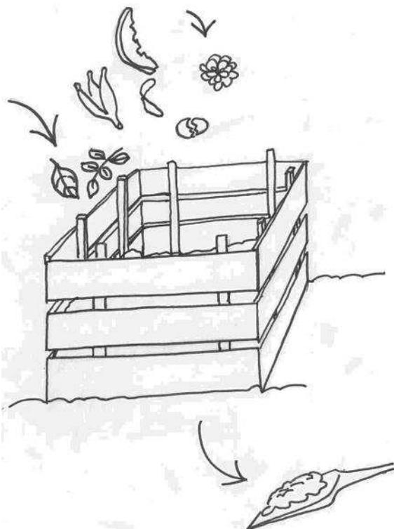
Un composteur peut être fabriqué facilement à l'aide de palettes ou de planches de récupération d'un mètre de longueur environ, assemblées avec des pointes sur des piquets.
