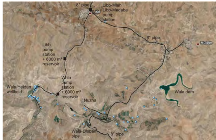
Figure 5 : Situation du barrage Wadi Wala et du champ de captage Wala/Heidan, avec le réseau d'approvisionnement en eau (les zones vertes entre le réservoir et le champ de captage représentent les zones irriguées).
