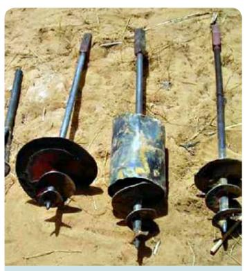
Fig. 2.15 Auger bits
