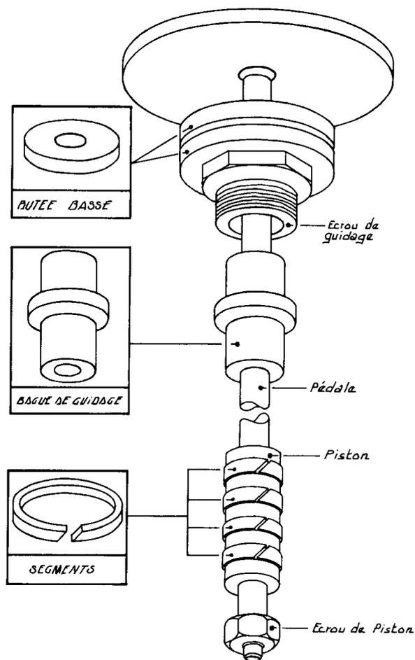
La **fontaine et le mécanisme de surface** comprennent :
