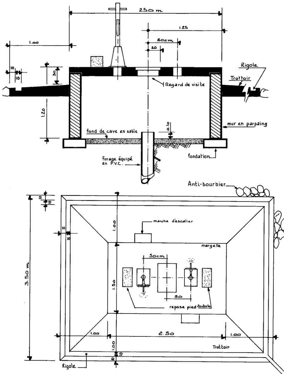
Afin d'installer une double pompe VERGNET, il est recommandé de construire une superstructure plus complexe qui comprend
