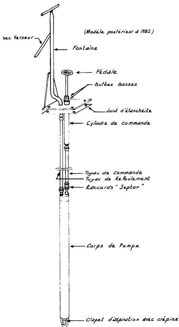
**Schéma de la pédale de la pompe VERGNET (Source : Comité Interafricain d'Etudes hydrauliques, Utiliser une pompe manuelle - Manuel de formation des formateurs villageois – Le point d'eau au village : aménagement ; utilisation ; entretien – série hydraulique villageoise livret 3, GH Géohydraulique, CINAM – date non connue)**
