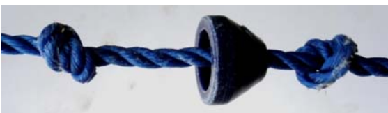
PE piston on the rope
