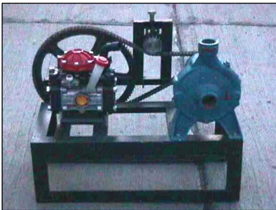
Ilustración 8 : Turbo pompe réalisée par le GEA
