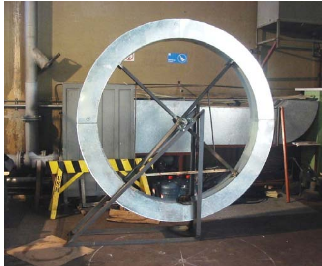
Illustración 17 : Nouvelle roue hydraulique de 2,25m de diamètre pour le projet
