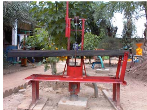
Photo 3 : Pompe Nafa profondeur.
