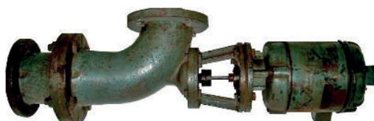
Première pompe de circulation de chauffage, la « pompe coudée », modèle de 1929, HP type DN 67/0,25 kW
