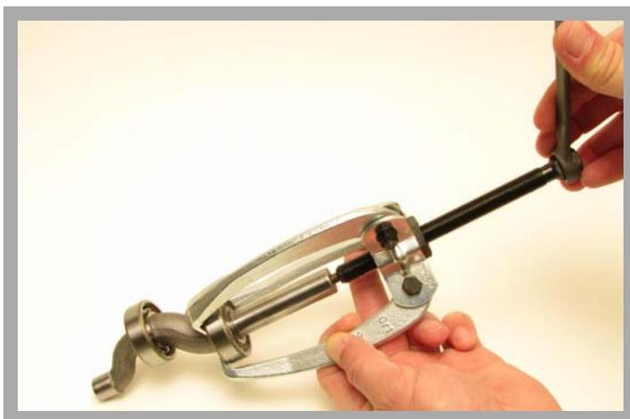
Démontage de la pompe à piston: démonter le roulement à billes de l'arbre excentrique (avec l'aide d'un extracteur)
