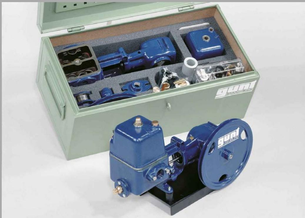
L'illustration montre la caisse à outils avec jeu de pièces et outils et, à l'avant-plan, la pompe complètement montée.
