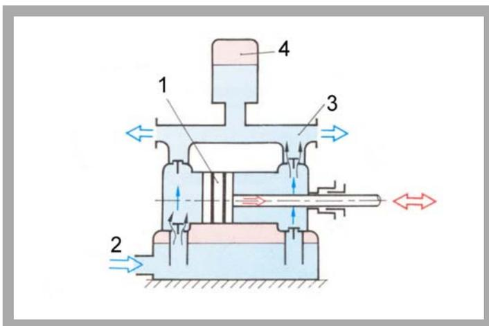
Principe d'une pompe à piston à double effet: 1 piston, 2 conduite d'aspiration, 3 conduite de refoulement, 4 réservoir d'air
