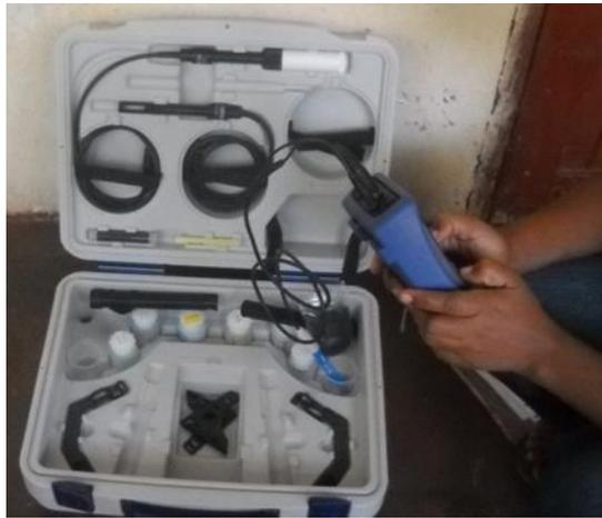
**Figure 5** : Photo du kit multiparamètre modèle Multi 340i (RAJAONARIVELO, 2012)
