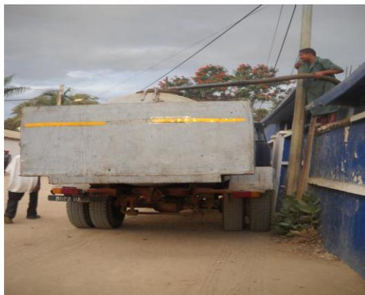
Figure 20 : Pompage de l'eau usée de la MUREX pour transport à Ankoronga (RAJAONARIVELO, 2013)
