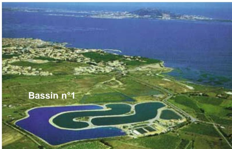
Les eaux usées débarrassées des gros objets et des graisses passent alors dans le premier bassin. Dans une station de lagunage, ce bassin est généralement le plus grand. À Mèze, il représente une surface de 4 ha, pour une profondeur moyenne de 1,30 m. Il est légèrement surcreusé à l'amont, où arrivent les eaux usées, afin d'éviter tout phénomène de comblement accéléré. Sa forme arrondie en U évite les angles morts
